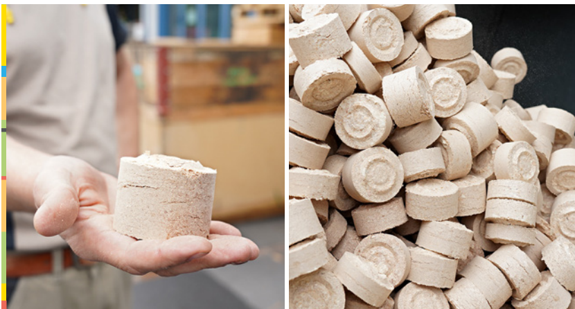
Die Späne werden automatisch abgesaugt, zu Pellets gepresst und landen schliesslich im Anhänger – und sind somit bereit für den Transport.
